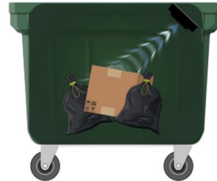
DIAGONĀLĀ MĒRĪŠANAS IESPĒJA KONTEINERIEM KAS IR ATVĒRTA TIPA
