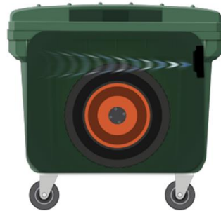
VERTIKĀLĀ MĒRĪŠANAS IESPĒJA AR MONTĀŽU UZ KONTEINERA SĀNA SIENAS
